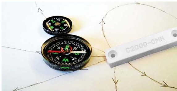
Рис. 1. Определение полярности магнита №1
